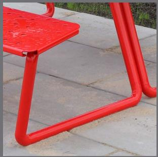
Stel er fremstillet af stålrør ø42,4 x 3,25 mm, der efterfølgende er varmgalvaniseret iflg. DS/EN ISO 1461. Kan eventuelt pulverlakeres i standard RAL farver efter ønske.
